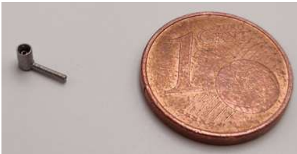
Figure 5 Mikro-Kielsonde (D=1.6mm) – nicht verlängert
